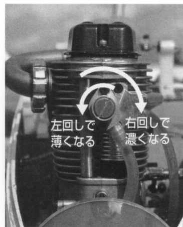
↑レギュレーターの調整は、前から見て「左」に回すと圧力が下がって薄くなり、「右」に回すと濃くなっていく。
