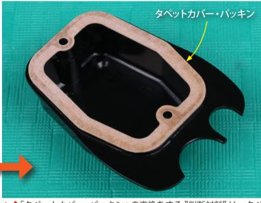
◆↑「タペットカバー・パッキン」の交換をする "判断材料" は、タペットカバーのネジを外したときに「タペットカバー」が簡単に外れるようなら即交換となる。反対に、ネジを緩めても外れないようなら気密性がある…ということで取り替える必要はないということである。但し、「タペットカバー」を外したときは必ず「タペットカバー・パッキン」を交換すること。このパッキンは紙製なので、使い回しをすると油が漏れることになるため要交換パーツとなっている。
