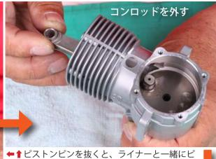
ストンも取り外せる。次にクランクシャフトを 上死点の位置に回転させて、コンロッドを取り 外していく(注※上死点でなくては外れない)。
