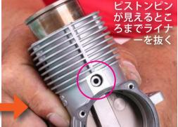
►ピストンを下死点の位置 に動かしてライナーを抜 き取っていくのだが、こ の時に、エンジン後方の ゴム製カバーを取り外し た「穴」を見ながら、ピ ストンピンが完全に見え るところまで抜いていく。
