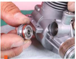
◆クランクシャフトを抜くた めには「カム」を外さない といけないので、まずはカ ムカバーを取り外していく。 ■カムカバーを取り外すと中 に「Oリング」があるので、 分解したついでに、これも 交換しておくといいだろう。
