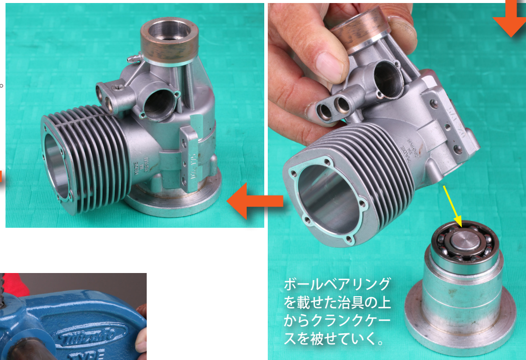
↑後方のボールベアリングを取り付けるための「治具」を用意して、写真のように「治具」の上にボールベアリングを載せる。
