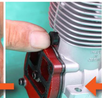
↑ピストンピンを抜き取るための「穴」を塞ぐゴム製のカバーは忘れずに取り付けること。
