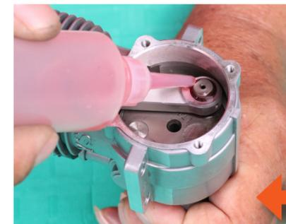
↑コンロッドの両端にあるメタル部分にクロットオイルを流し、続けてキャブ関係を組み込んで完成させていこう！
