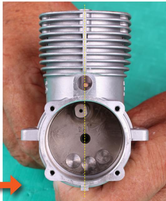
↑写真のように「クランクシャフトのピン」が上死点の少し手前になるようにセットする。この位置をキープしたままの状態、「カム」を組み立てていこう。
