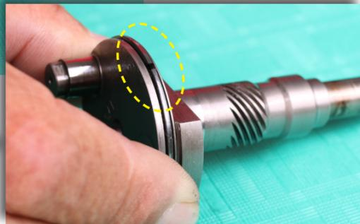
←この「専用工具」をクランクケースの後方にセットしたら、続けてクランクシャフトを挿入していく。たったこれだけの専用工具だが、これがないとクランクシャフトは入れられない。
