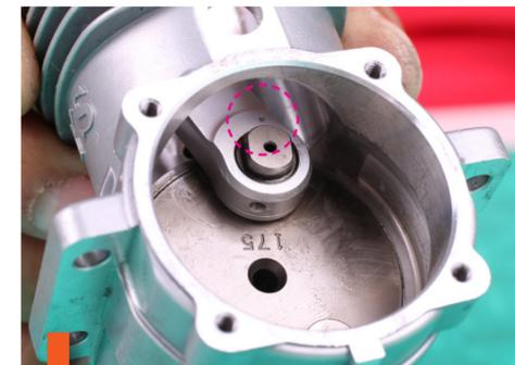
→カムフォロワーはバケツ型になっていて、底が下になるように挿入すること。挿入する前には、クロットオイルを適量を流しておくベストである。
