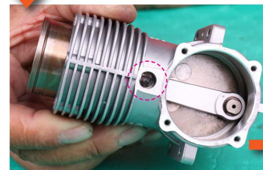
←ピストンピンの取り付けは、ピストンとライナーが一緒の状態のままクランクケースの中に挿入し、ピストンの「ピンの穴」が見えたらピストンピンを挿入していこう。
