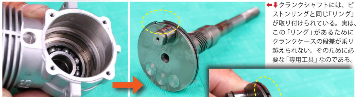
クランクシャフトには、ピストンリングと同じ「リング」が取り付けられている。実は、この「リング」があるためにクランクケースの段差が乗り越えられない。そのために必要な「専用工具」なのである。
