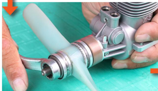
↑クランクシャフトにテーパコレットとドライブワッシャーをセットし、ナットでプロペラを締め付けるとこの作業は完了だ。
